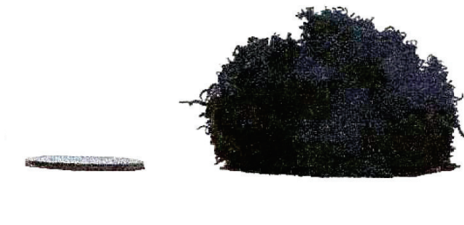
Intumex® L in rohem und aufgeblähtem Zustand
